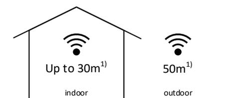
Casambi verwendet die MESH Netzwerk-Technologie. Jedes Casambi Gerät verhält sich wie ein Repeater und frisst das empfangene Bluetooth Signal für die folgenden Geräte auf.
