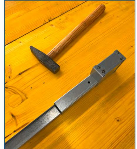
**3** Mit Hilfe einer separat bereitgestellten Skizze, Plan oder Zeichnung, wird der Einlegekanal auf den Grundkanal montiert.
